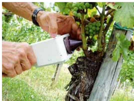
FIGURA 4. Impiego del NIR-AOTF per la predizione del flusso vascolare nella vite (turgore)
